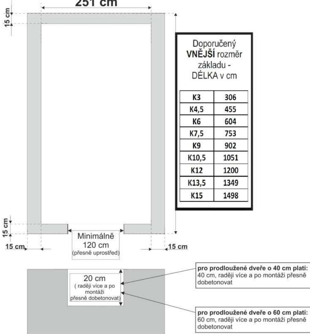
Doporučujeme pevné betonové základy ( lze použít i ztracené bednění). Pouze v případě řádného ukotvení skleníku k pevným základům lze dát plnou garanci za stabilitu skleníku dle statických výpočtů.
