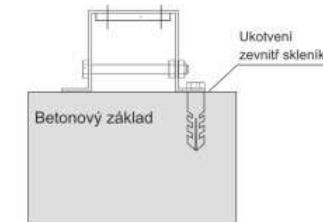
V základnách jsou připravené otvory k ukotvení skleníku.
