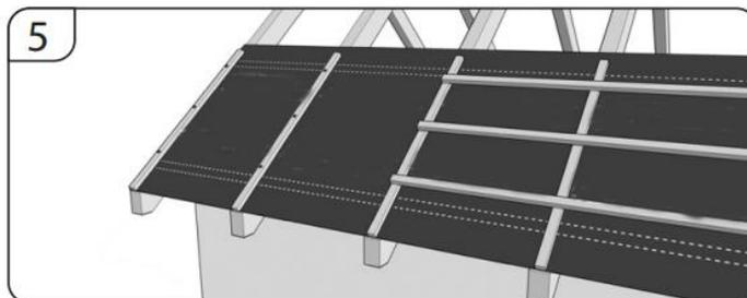
6. Další pás fólie by měl být aplikován s přesahem 10-15 cm (se sklonem střechy pod 25 stupňů - 20 cm). Aby byla montáž střešní fólie efektivní a přesahy byly vodotěsné, použijte jednostrannou pásku (např. Guttaband Extra) nebo oboustrannou páskou (např. Reparband) při spojování jednotlivých pásů membrány.
